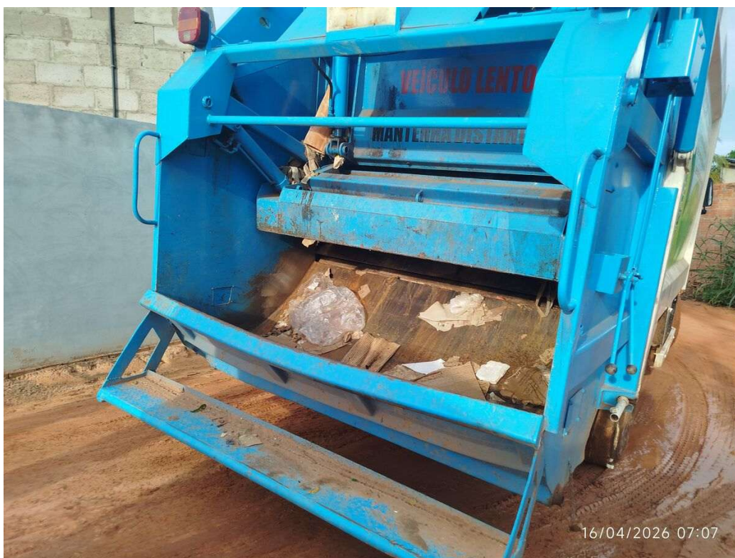
Foto 4 – Vista traseira do mecanismo compactador. Interior da calha com resíduos de papelão e sacaria plástica remanescentes. Presença de ferrugem no mecanismo.
