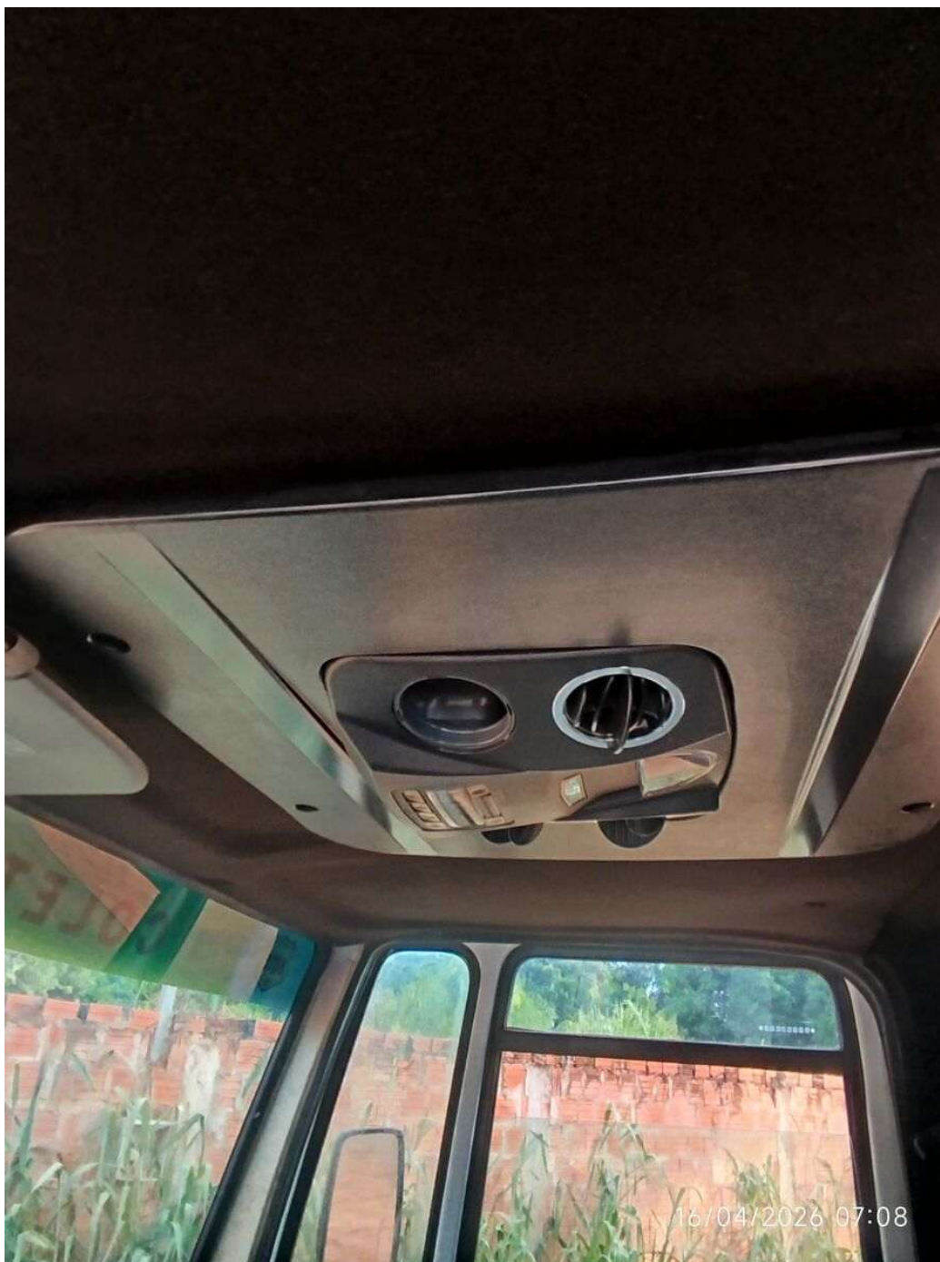
Foto 7 – Teto interno da cabine: forração presente, unidade de ar condicionado instalada, luz de teto e trava de acesso visíveis.
